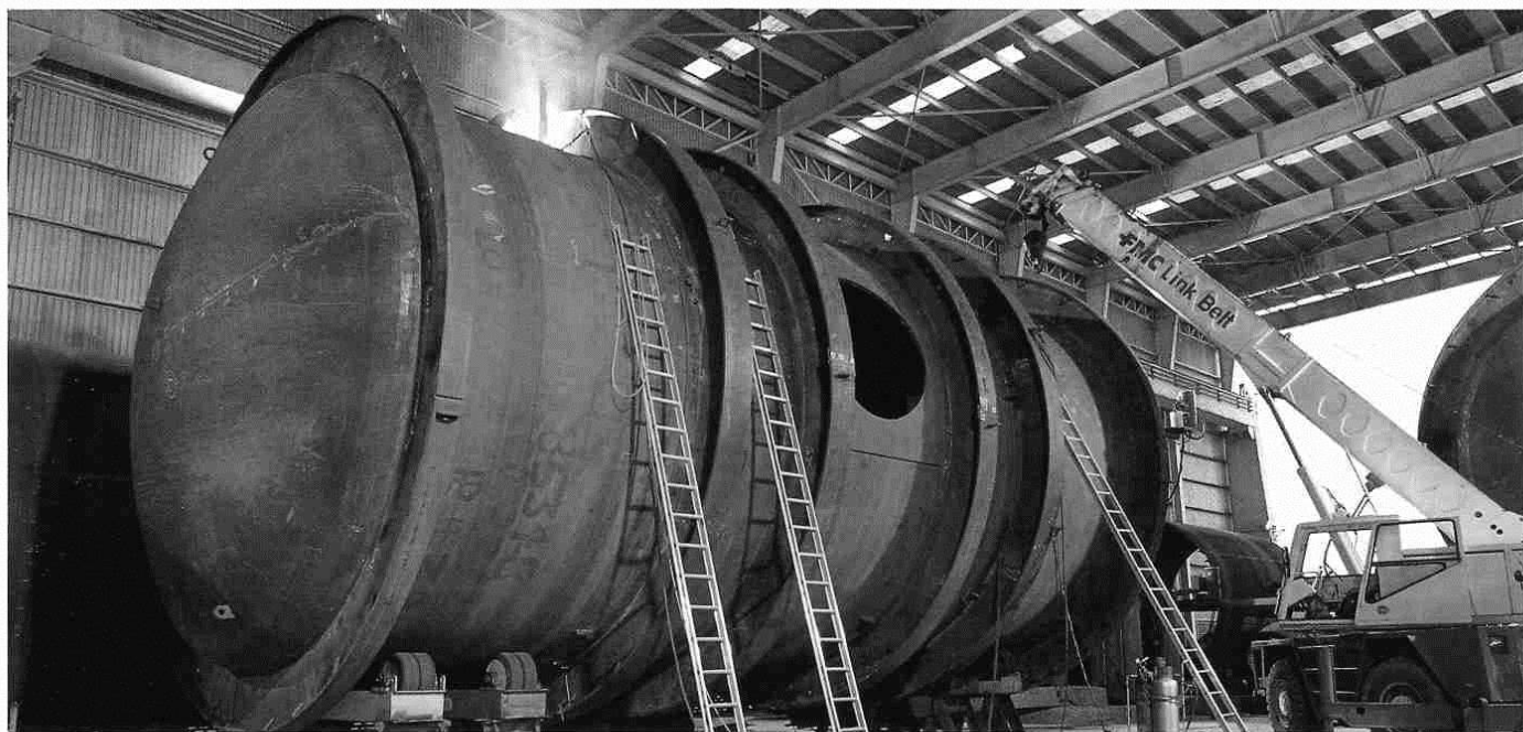
Reactores de proceso "Catofin" para la obtención de gasolinas, en proceso de fabricación en la planta de IH en Tampico; abajo, torre absorbedora de \text{CO}_2 para una planta de amoniaco, fabricada para Petróleos Mexicanos.
